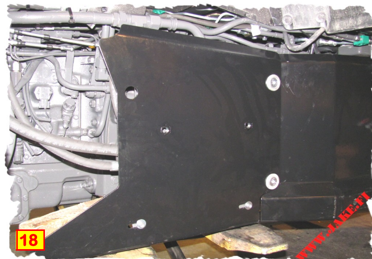
Asenna oikean puolen sivupanssarit ennen apurunkoa. Instal the right side armours before the aid frame.
